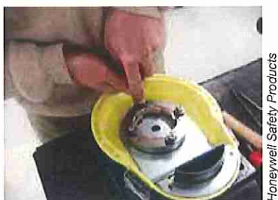
Fig. 4 Vérification des parties mécaniques d'un enrouleur de rappel d'un EPI anti-chute
