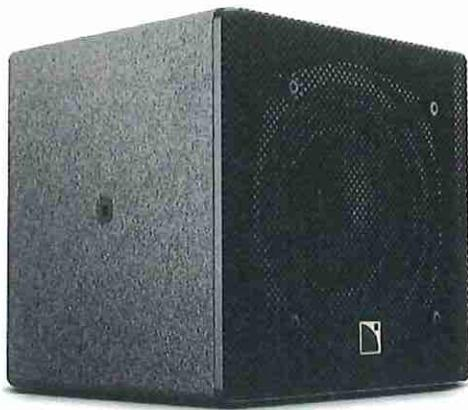
Le 5XT est un système coaxial ultra-compact conçu pour la sonorisation de courte portée avec un impact visuel réduit à son minimum. Le 5XT est équipé d'un moteur à chambre de compression à diaphragme de 1" chargé co-axialement par un haut-parleur grave-medium de 5" dans une enceinte bass-reflex.
